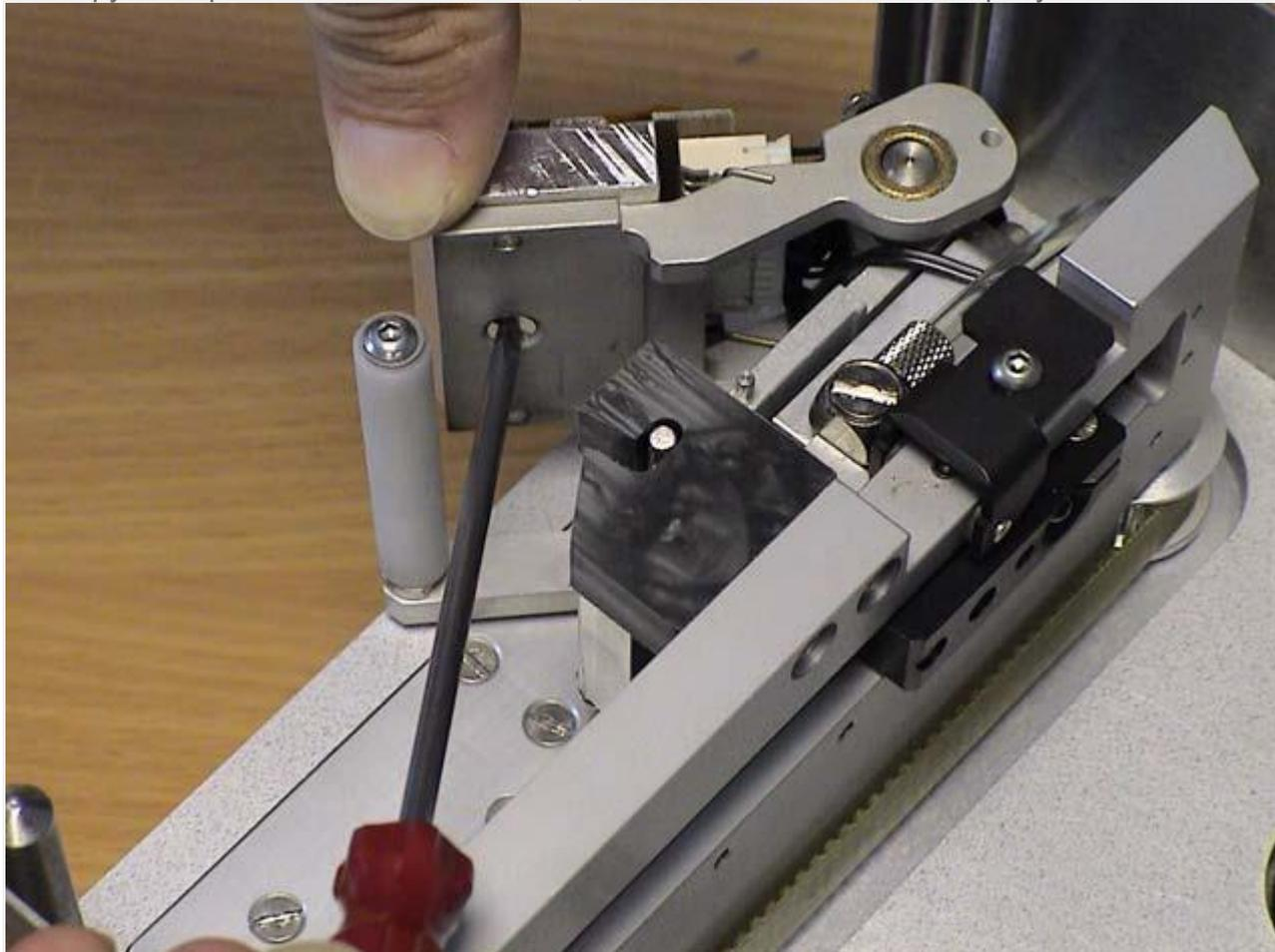
Рис 1-01: Откручиваем печатающую головку
