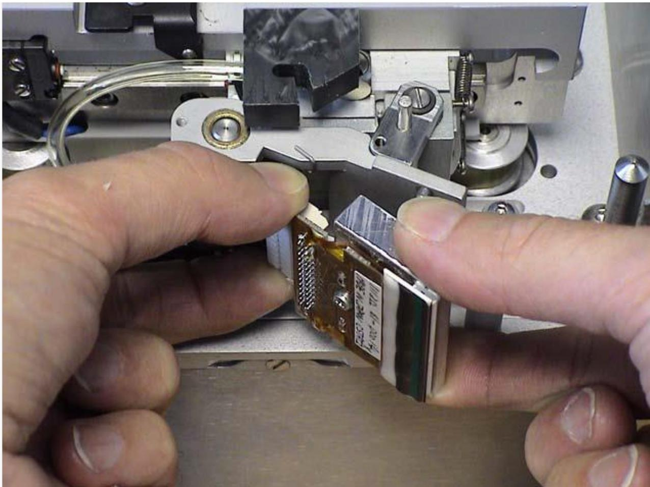
Рис 1-02: Снимаем печатающую головку
