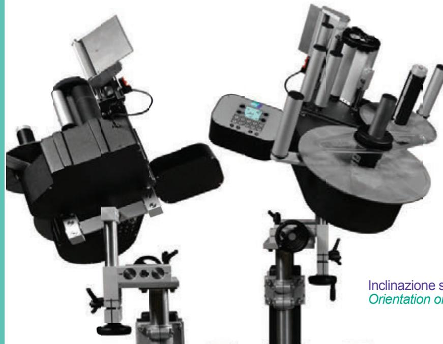
Le regolazioni sono fissate mediante Arca Clip per il posizionamento, in fase di installazione, all'altezza più opportuna
