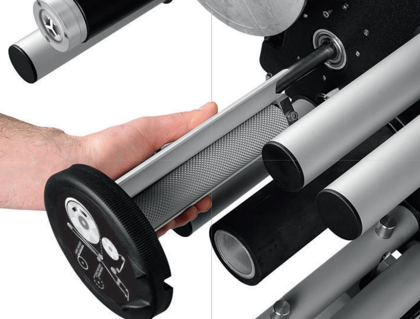
Il gruppo di trazione della serie 3000 si apre con un dito. È totalmente accessibile per garantire interventi rapidissimi. Il controcilindro si estrae "a scatto" senza impiego di utensili per facilitare le operazioni di pulizia
