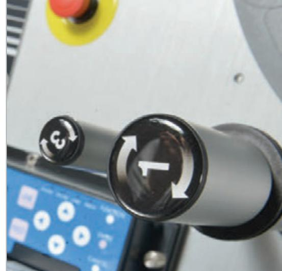
Tutti i rulli che guidano la banda sono protetti con tappo per evitare il deposito di sporcizia. La numerazione sequenziale o gli appositi schemi facilitano la preparazione della macchina
