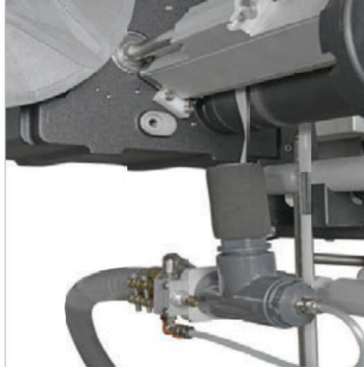
L’aspiratore per supporto siliconato “stretto”, utilizzato in alternativa al riavvolgitore, può evacuare il supporto verso un tritatore. E’ praticamente indispensabile per l’impiego di rotoli “Spool Reel” ad altissima capacità
