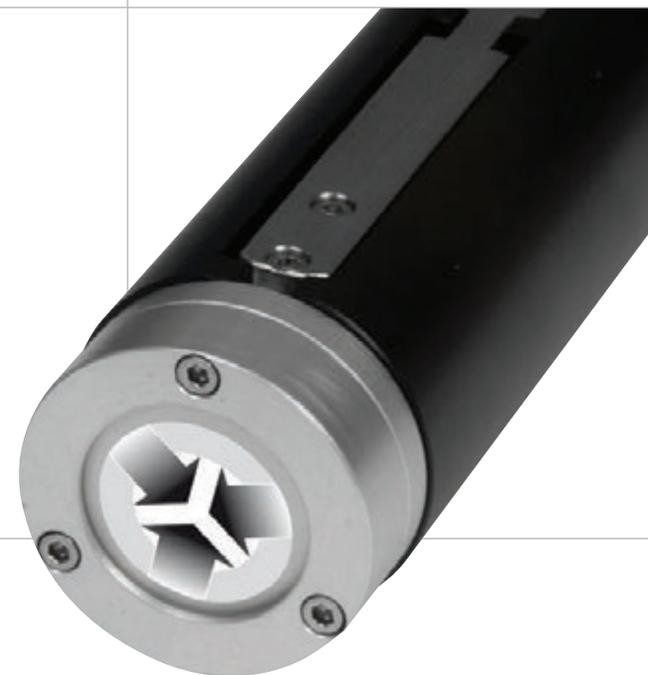
Nel riavvolgitore, il mandrino a diametro variabile facilita la rimozione del supporto siliconato. Il mandrino è normalmente espanso così che l'operatore non debba effettuare alcuna operazione e non possa dimenticarsi di armarlo
