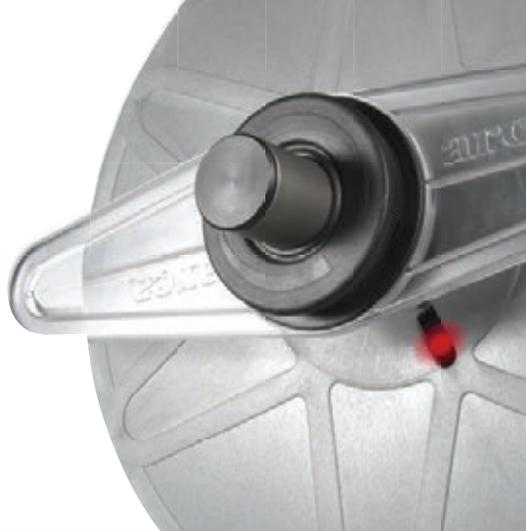
Il pre-allarme “avvicinarsi fine rotolo” avvisa l’operatore affinché questi si prepari alla sostituzione. Arca impiega un dispositivo ottico (senza tastatori meccanici) che non ingombra e non richiede alcuna operazione da compiere per armarlo
