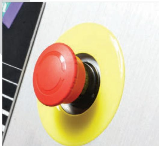
I print apply serie Bi-Fuel sono dotati di pulsante di emergenza che interrompe anche i circuiti pneumatici
