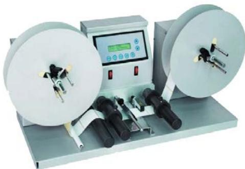
Семейство перемотчиков LABELS COUNTER - это устройства предназначенное для перемотки и пересчета рулонных самоклеющихся этикеток с одновременным нанесением дополнительной информации с помощью каплеструйных принтеров. Устройство позволяет устанавливать счетчик деталей, скорость перемотки, и останавливает вращение двигателя в конце рулона или в случае разрыва бумаги. Програмируется возможность остановить или не выполнить операцию перемотки в случае отсутствия ярлыков.
