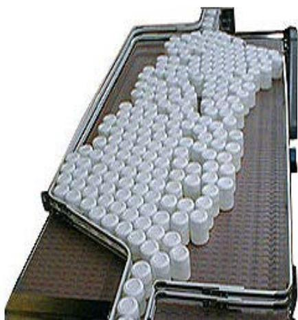
Межоперационные накопительные столы обеспечивают равномерность потока продукции между технологическими операциями. Устройство состоит из основания, участка транспортера, "врезаемого" в основную линию и оборудованного датчиками, непосредственно накопительного стола, оснащенного лентой с приводом и щита управления. Наша компания производит накопительные столы под ваши технические требования. Лучшие современные комплектующие обеспечат долговременную бесперебойную работу оборудования на долгие годы.
