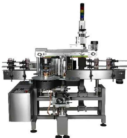
Система предназначена для нанесения этикетки и контрэтикетки на продукты овальной формы. Благодаря ориентирующему устройству выравнивает продукт в одном положении перед нанесением этикетки. В момент нанесения этикетки продукт проходит под верхним прижимным конвейером, чтобы обеспечить оптимальный результат маркировки. Возможна различная конфигурация: с большими конвейерами, делителями, системами печати и т.д. Возможна специальная опция для нанесения этикеток так же на цилиндрические объекты.
