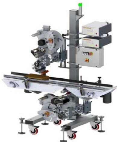
Этикетировочная система для нанесения этикетки на верхнюю и нижнюю сторону продукта. Максимальная производительность 2000 - 6000 этикеток/час в зависимости от размера изделий. Максимальная ширина этикетки: 140 - 250 мм. Поставляются в комплекте с верхней и нижней этикетировочной головкой, так и по отдельности. Дополнительно возможна установка модуля каплеструйной, термоструйной или термотрансферной печати.
