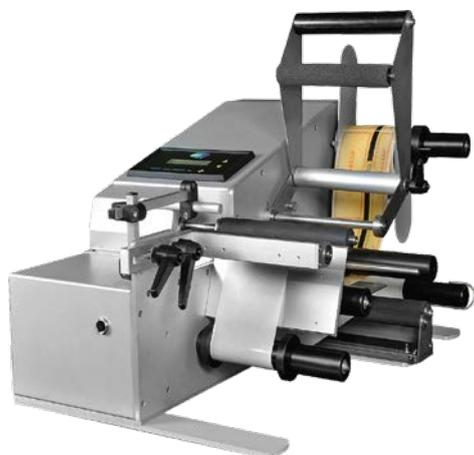
Система предназначена для этикетирования бутылей, банок, емкостей, продуктов, имеющих округлую форму. Это самый доступный и простой способ нанесения этикетки на продукт. Машина управляется в ручном режиме. Продукт размещается в горизонтальном положении. Электрический привод. Этикетка наклеивается ровно, без пузырей и волн. Машина легко адаптируется к различным типоразмерам тары и этикетки. С помощью этой этикетировочной машины Вы можете наклеивать до 1500 этикеток в час.
