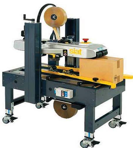
Заклейщики коробов (гофрокоробов) проклеивают короб клейкой лентой сверху и снизу (либо по желанию только с одной стороны) и настраиваются под размер гофрокороба (ширину и высоту) вручную оператором. Настройка осуществляется при помощи регуляторов и занимает около 2-х минут.
