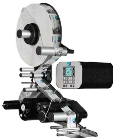
Аппликатор модели L-160 EVOLUTION правого и левого исполнения. Максимальная рабочая регулируемая скорость до 50 м/мин. Эффективная частота наклеивания зависит от размеров и материала этикеток, материала подложки, расстояний между движущимся продуктом, а так же типом пилера и положением самого аппликатора.
