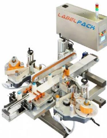
Этикетировочная система для нанесения этикетки на овальные продукты. Система подходит для маркировки продуктов таких как бутылки, канистры, флаконы. Максимальная скорость 3000-10000 шт / час в зависимости от размеров продукции. Максимальная ширина этикетки: 140 - 250 мм. Дополнительно возможна установка модуля каплеструйной, термоструйной или термотрансферной печати.
