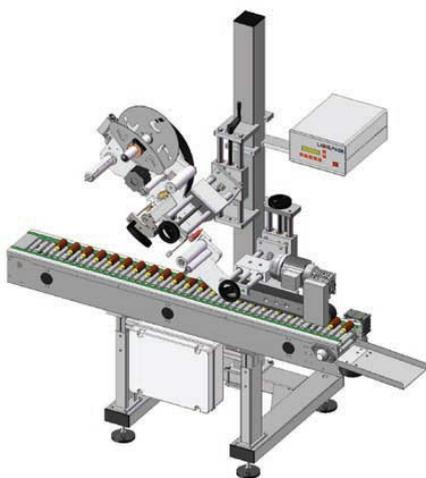
Этикетировочная система для нанесения колцевой этикетки на цилиндрические продукты. Система подходит для маркировки ампул, флаконов, пробирок, колбасы и т.д. Производительность 3600 этикеток/час. Максимальная ширина этикетки: 140 - 250 мм. Дополнительно возможна установка модуля каплеструйной, термоструйной или термотрансферной печати.
