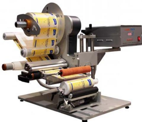
Полуавтоматические аппликаторы LABELX серии TR - предназначены для нанесения этикетки на цилиндрический продукт диаметром от 30 до 120 мм. Подача и сьем продукта осуществляется оператором в ручном режиме. Полуавтоматы оснащены специальным устройством вращения продукта, состоящим из двух обрезиненных валов с приводом. Дополнительно возможна установка модуля каплеструйной, термоструйной или термотрансферной печати.
